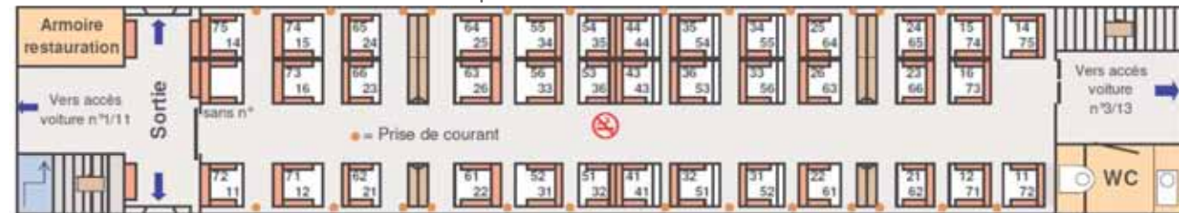
VOITURE N° 2 OU 12 - 1 ère classe, 38 places assises - Armoire restauration
